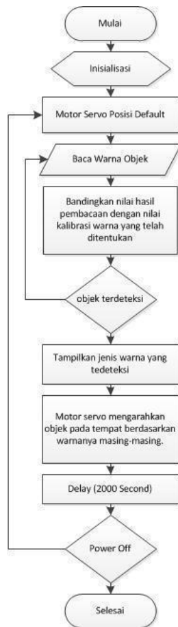
Gambar 3.1 Diagram Alir Prototipe Alat Sortir Bola
