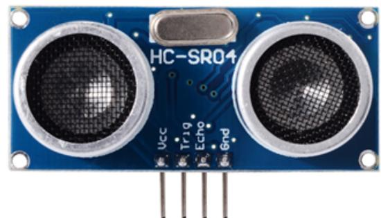
Gambar 3 Perangkat Sensor Ultrasonik HC-SR04
