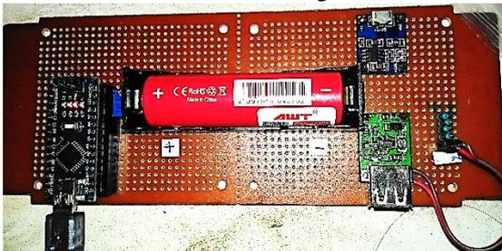
Gambar 8. Integrasi pengujian baterai pada board yang sama
