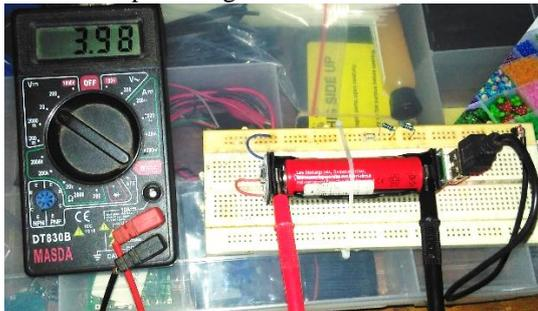
Gambar 7. Pengukuran tegangan baterai menggunakan multimeter digital
